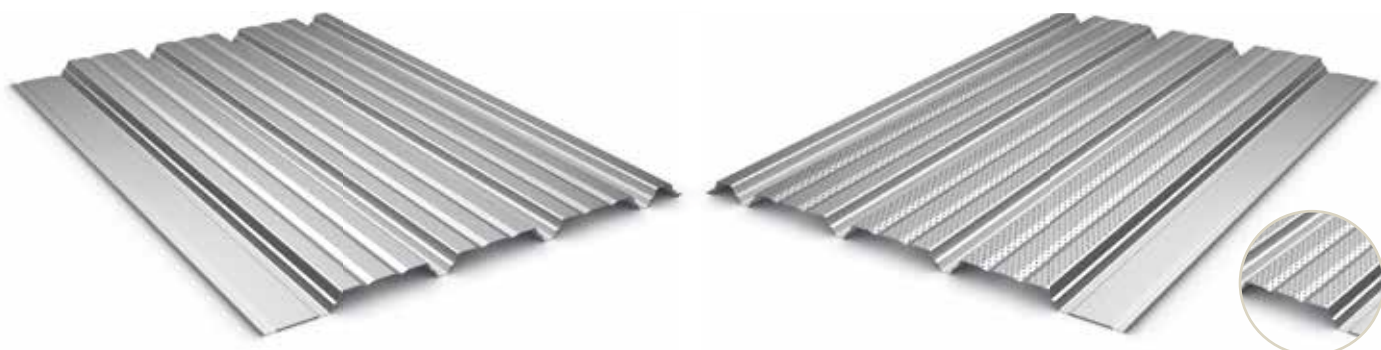
Version perforée type P - Sur plages Vide de perforation 15 % - ø 5 mm Entraxe 12,5 mm
