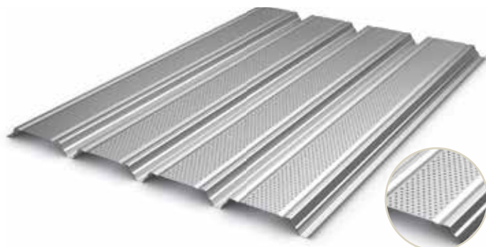
Version perforée type P - Sur plages Vide de perforation 15 % - ø 5 mm Entraxe 12,5 mm
