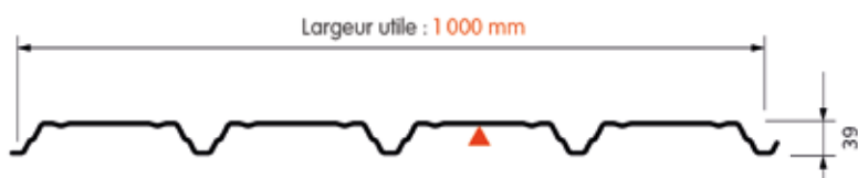
Version crevée type C Vide de perforation 15 %
