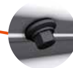
Couturage des panneaux 1 vis/m minimum
