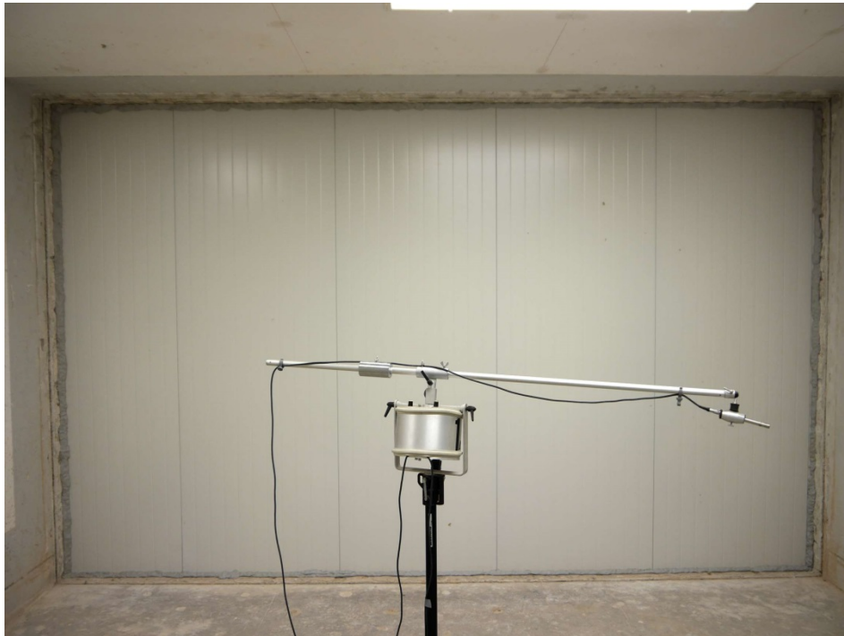
Abbildung 1. Mineralwollpaneele Typ PFLAUM FE-010/010 100 0,50/0,50 während der Prüfung im Wandprüfstand.
