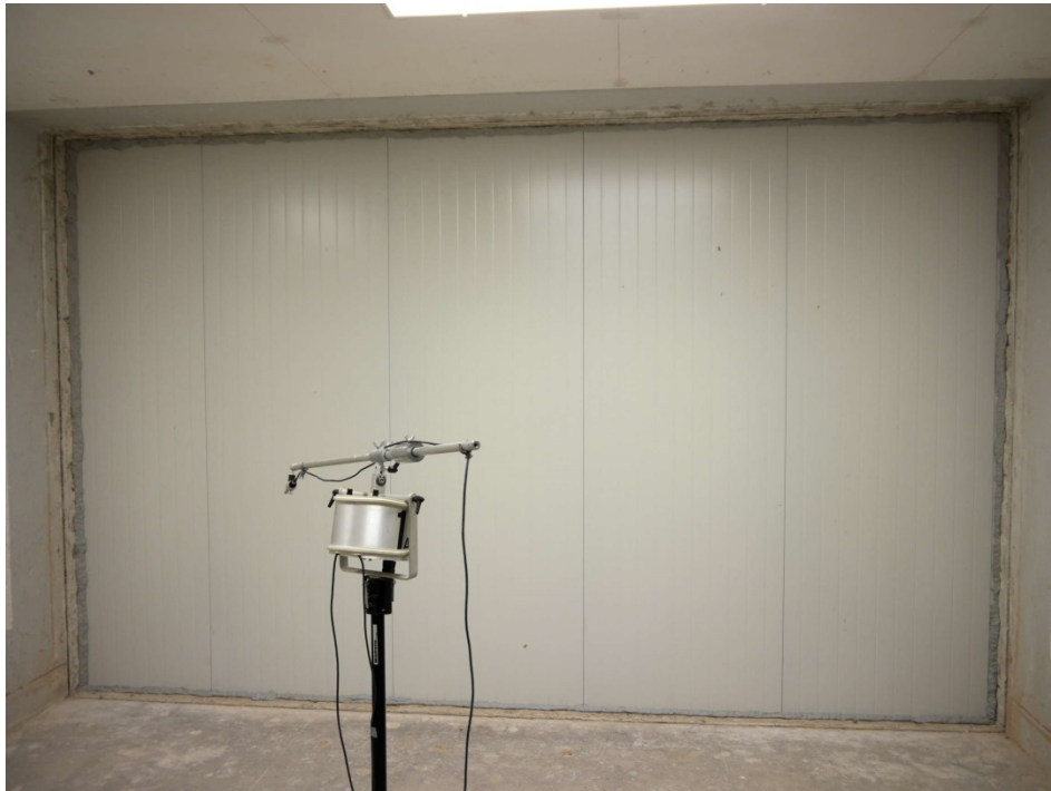
Abbildung 1. Mineralwollpaneelle Typ PFLAUM FE-010/010 100 0,75/0,75 während der Prüfung im Wandprüfstand.
