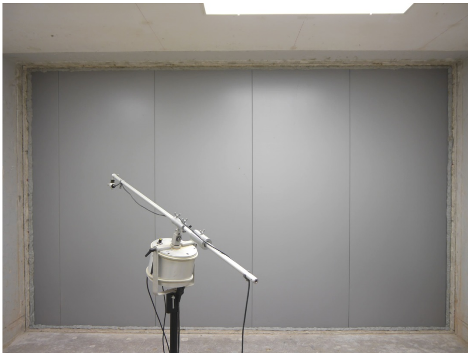
Abbildung 2. Mineralwollpaneele Typ PFLAUM FE-0/AK 100 0,55/0,55 während der Prüfung im Wandprüfstand (empfangsraumseitig glatt, ohne Lochung).
