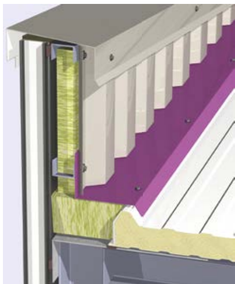
Rive en solin Exemple : Promisol® V1150 en pose verticale
